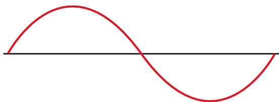
Однако, форма тока отличается от идеальной синусоидальной, поскольку на электрические сети влияют гармоники: колебания более высокого порядка, вводимые различными типами электрооборудования.
