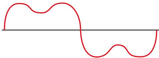
Гармоники в электрических системах могут вызывать негативные последствия, такие как перегрев или неисправность оборудования, подключенного к сети. При уровне гармонических искажений THDi 40%, появится потребность в увеличении размера привода примерно на 35%.
