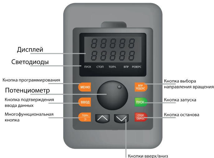
Рис. 5.1.1 Функции кнопок и светодиодов панели управления
