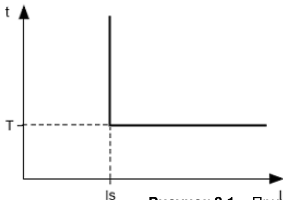
Рисунок 3.1 – Принцип защиты с независимой выдержкой времени
