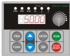
Рисунок 3-2 Остановка Заданная частота "50.00"
