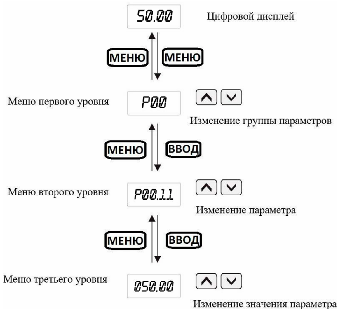
Рисунок 6.1 – Схема настройки параметров меню
