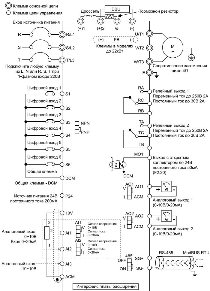
Стандартная конфигурация для ПЧ мощностью до 4 кВт (включительно).
