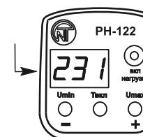
По завершении отсчета времени АПВ на дисплее отобразится значение напряжения сети, в розетке PH-122 появится напряжение, загорится светодиод **ВКЛ НАГРУЗКИ**
