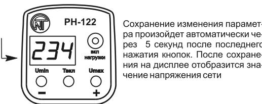
Сохранение изменения параметра произойдет автоматически через 5 секунд после последнего нажатия кнопок. После сохранения на дисплее отобразится значение напряжения сети
