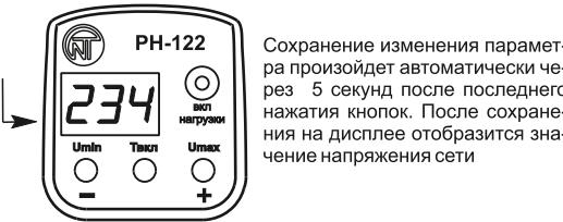
Сохранение изменения параметра произойдет автоматически через 5 секунд после последнего нажатия кнопок. После сохранения на дисплее отобразится значение напряжения сети
