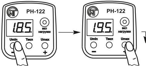
Нажмите кнопку **Umin/-** – на дисплее отобразится заводская установка параметра с мигающими точками (**185.**)
