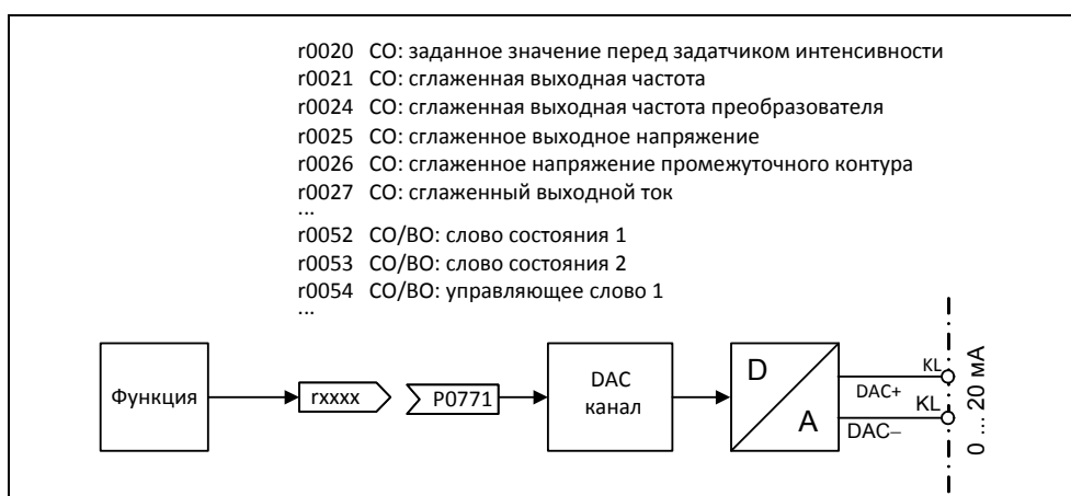
Рис. 3-27 Вывод сигнала через канал DAC
